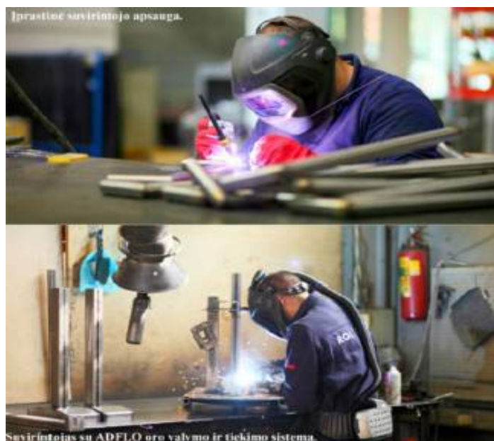
5 pav. Suvirintojas su įprastine apsauga ir su projekto metu įgyta oro valymo ir tiekimo sistema
