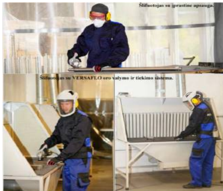
3 pav. Metalu gaminių šlifautojas su įprastine apsauga ir su projekto metu įgyta oro valymo ir tiekimo sistema
