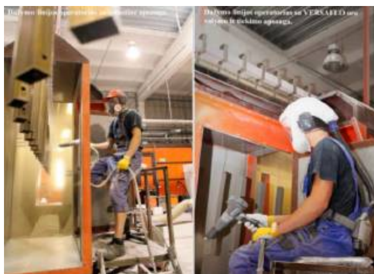
4 pav. Dažymo linijos operatorius su įprastine apsauga ir su projekto metu įgyta oro valymo ir tiekimo apsauga
